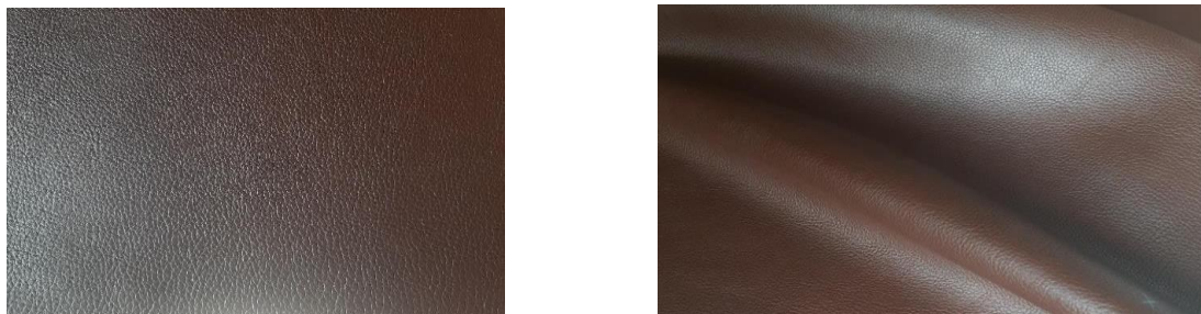
Gambar 3b. Kulit Nappa Softy Mill sebelum refinishing (warna kulit rata kulit lebih kompak, semi gilap/semi glossy, lipatan-lipatan tidak tampak); Sumber : Foto kulit oleh tim peneliti
