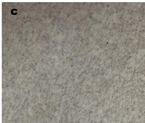
Gambar 1. Sampel hasil kulit sintetis dengan penambahan limbah shaving sebesar 8% (a); Sampel hasil kulit sintetis dengan penambahan limbah shaving sebesar 16% (b); Sampel hasil kulit sintetis dengan penambahan limbah shaving sebesar 20% (c).
