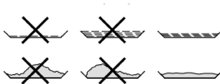
Gambar 3. Cara Pengaplikasian Sampel (Sumber : Sartorius Weighing Technology GmbH 2012)
