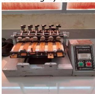
**Gambar 1.** Mesin Crockmeter Sumber Politeknik ATK
